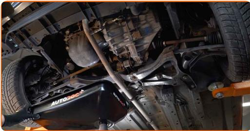
6 Desaperte o bujão de drenagem. Use uma chave soquete nº 15. Use uma chave de catraca.
