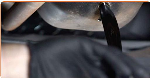
Substituição: óleo do motor e filtro – TOYOTA Camry III Carrinha (\_V1\_).
