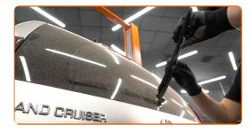
Pressione o clipe de fixação. Use uma chave de fenda plana.
