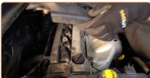
**5** Desconecte os conectores das bobinas de ignição.
