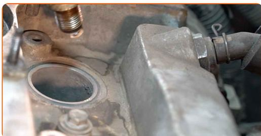
**12** Aplique uma camada fina de um lubrificante antigripante de alta temperatura específico às roscas das novas velas de ignição. Trate a superfície dos terminais das novas velas de ignição. Use massa de alta temperatura.
