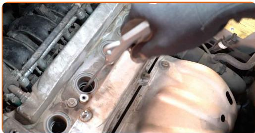
**10** Desaperte as velas de ignição. Use o soquete da vela de ignição #16. Use uma chave de catraca.
