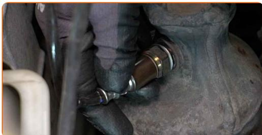
**22** Aperte o fixador do sensor de oxigénio. Utilize um encaixe de sensor de oxigénio de 22 mm. Use uma chave de torque. Aperte-o para o torque de 40 Nm.
