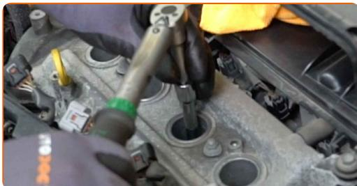
Substituição: vela de ignição – TOYOTA COROLLA FX Compact (E8B).
