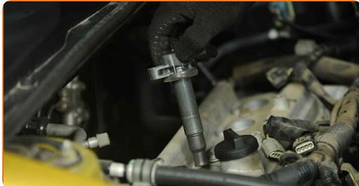
**15** Aperte os fixadores das bobinas de ignição. Use uma chave soquete nº 10. Use uma chave de catraca.
