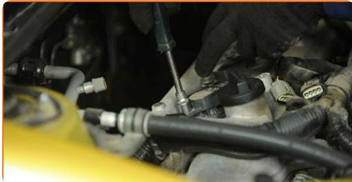
**16** Trate o conector da bobina de ignição com spray eletrónico. O spray protegerá os contactos elétricos contra a corrosão, oxidação e reduzirá a resistência do contacto.
