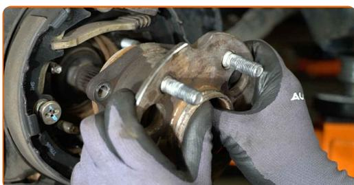
**30** Limpe o local de montagem do rolamento de cubo. Use uma escova metálica. Use o spray de limpeza universal.
