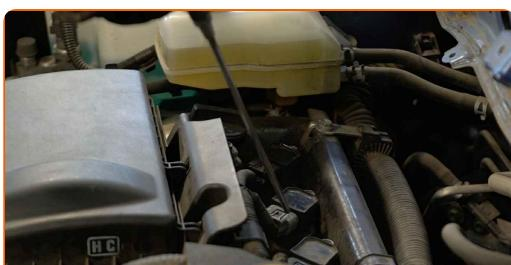
12 Desaperte os fixadores das bobinas de ignição. Use uma chave soquete nº 10. Use uma chave de catraca.
