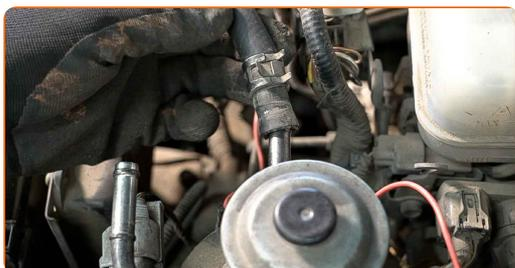
**31** Aperte as braçadeiras de fixação dos tubos do filtro de combustível. Use alicates de ponta arredondada.
