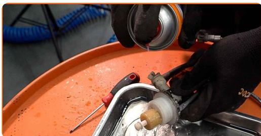
**23** Instale o novo anel de vedação do sensor de água (WIF).
