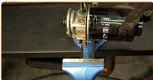
**19** Instale a caixa de proteção do filtro de combustível.
