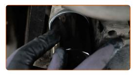
Aperte o filtro de óleo. Lembre-se de se certificar do torque de aperto recomendado. Use o soquete 65-14F. Use uma chave de torque. Aperte-o para o torque de 24 Nm.
