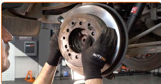
**17** Limpe o cubo. Use uma escova metálica. Trate a superfície de contacto. Use massa de cobre.
