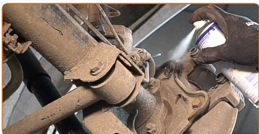
**13** Desaperte a fixação da braçadeira da pinça. Use uma chave soquete nº 17. Use uma chave de tarraxa.
