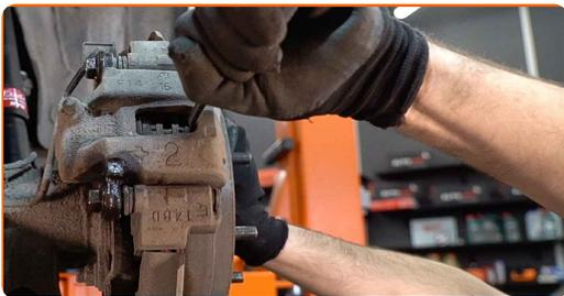
**9** Desparafuse a fixação de pinça de travão. Use uma chave soquete nº 17. Use uma chave de tarraxa.
