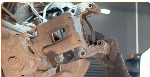
**15** Limpe a superfície do disco de travão. Use uma escova metálica. Use spray WD-40.
