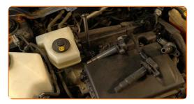
Aparafuse as novas velas de ignição e aperte-as. Use o soquete da vela de ignição #16. Use uma chave de torque. Aperte-o para o torque de 18 Nm.
