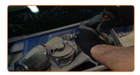
Aparafuse os fixadores da caixa de fusíveis. Use uma chave soquete nº 10. Use uma chave de catraca.
