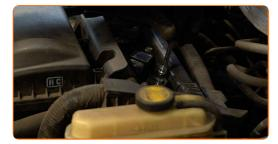
Retire as bobinas de ignição dos poços das velas de ignição.
