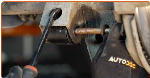
**16** Aperte o fixador que conecta o braço arrastado à carroçaria do automóvel. Aparafuse o elemento que fixa o braço de suspensão à viga do eixo traseiro. Use uma chave combinada nº 19.
