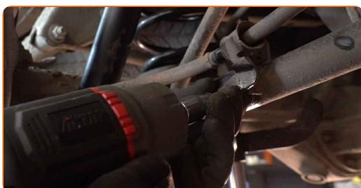
**12** Retire os parafusos de fixação.
