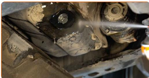
**26** Reinstale a tampa inferior do cárter de óleo.
