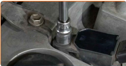
**16** Retire os parafusos de fixação.
