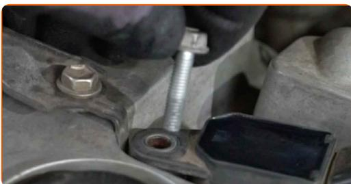
**17** Retire as bobinas de ignição dos poços das velas de ignição.
