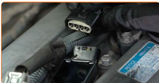
**15** Desaperte os fixadores das bobinas de ignição. Use uma chave soquete nº 10. Use uma chave de catraca.
