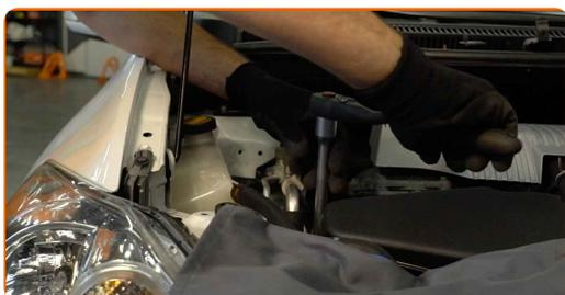
**14** Desaperte o fixador superior do apoio do motor. Use uma chave soquete nº 17. Use uma chave de catraca.
