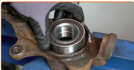
**Substituição: rolamento da roda – TOYOTA Prius C Hatchback. AUTODOC recomenda:**
