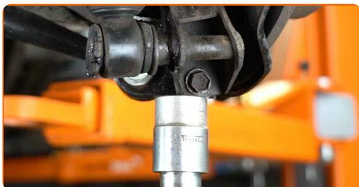
**14** Desaperte a fixação superior do amortecedor.
