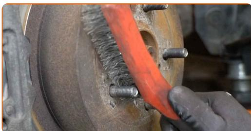
**28** Trate a superfície onde o disco de travão entra em contacto com o aro da roda. Utilize massa lubrificante de cerâmica.
