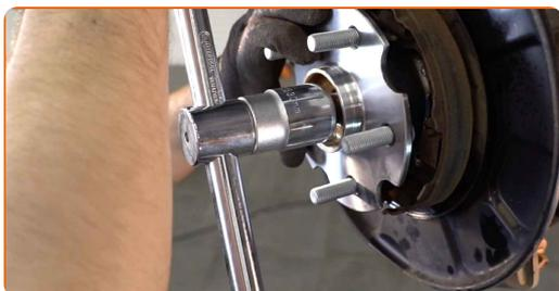
**28** Trate o cubo onde entra em contacto com o disco de travão. Use massa de cobre.
