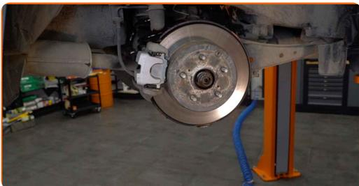
**9** Desaperte o fixador que liga o eixo de transmissão ao cubo de roda. Use uma chave soquete nº 30. Use uma chave de tarraxa.
