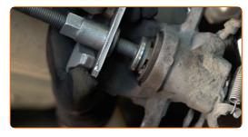
Instale a pinça do travão e fixe-o. Use uma chave combinada nº 17. Use uma chave soquete nº 14. Use uma chave de torque. Aperte-o para o torque de 35 Nm.
