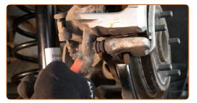
Desprenda o cabo do travão de estacionamento do suporte na pinça de travão. Use alicates de bomba de água.
