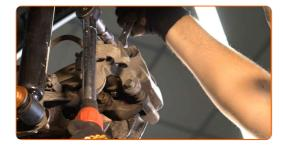
Instale o cabo do travão de estacionamento no suporte da pinça do travão.
