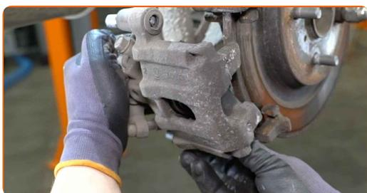
Substituição: rolamento da roda – TOYOTA Yaris Hatchback (\_P13\_).
