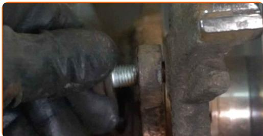
**38** Aperte os parafusos do suporte da pinça do travão. Use uma chave soquete nº 14. Use uma chave de torque. Aperte-o para o torque de 57 Nm.
