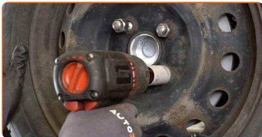
**50** Baixe o carro e trabalhar em ordem transversal, apertar os parafusos das rodas. Use o soquete de impacto para roda #21. Use uma chave de torque. Aperte-o para o torque de 103 Nm.
