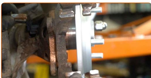
**37** Instale os parafusos de fixação.
