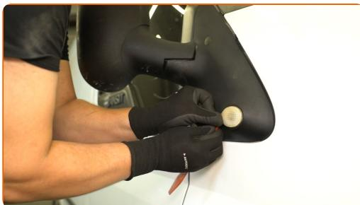
2 Desligar o conector da luz do pisca auxiliar.
