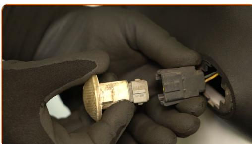
3 Tratar o conector da luz do pisca auxiliar. Utilizar um spray para componentes eletrónicos.
