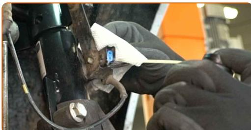
**18** Ligar o conector do novo sensor de desgaste das pastilhas de travão.
