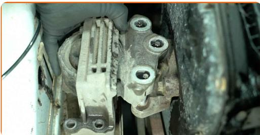
**9** Limpar os assentos de montagem do suporte do motor. Utilizar uma escova de arame. Utilizar spray de limpeza multiusos.
