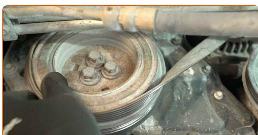
**4** Verificar o estado das polias do alternador e da bomba da direção assistida. Substituí-las, caso seja necessário.
