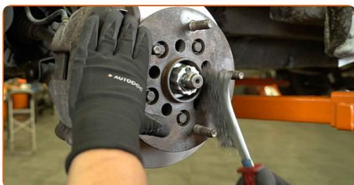
**28** Limpar a superfície do cubo da roda que está em contacto com a jante. Utilizar massa lubrificante de cerâmica.
