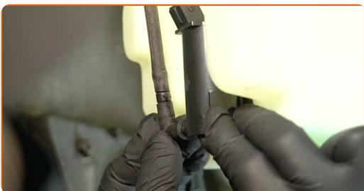
**22** Tratar o conector da bomba do limpa-vidros. Utilizar um spray para componentes eletrônicos.
