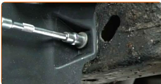
**26** Apertar o parafuso de fixação da cobertura do depósito do líquido do limpa-vidros. Utilizar uma chave de caixa de 10 mm. Utilizar uma chave de roquete.
