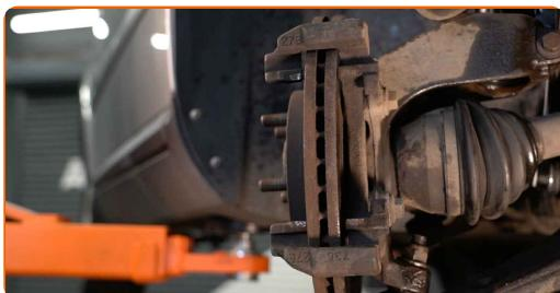
Substituição: pastilhas de travão – Volvo V50 MW. Conselho:
