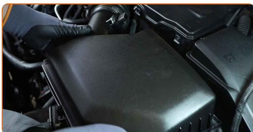
**12** Aparafusar os parafusos de fixação da tampa do filtro de ar. Use Torx T25. Use uma chave de catraca.
