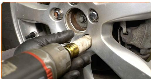
**27** Baixar o carro e trabalhar em ordem transversal, apertar os parafusos das rodas. Use o soquete de impacto para roda #19. Use uma chave de torque. Aperte-o para o torque de 140 Nm.
