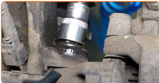
**13** Retire os parafusos de fixação.
