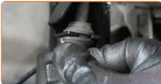
**80** Aperte os fixadores inferiores do dispositivo amortecedor. Use uma chave soquete nº 15. Use uma chave de torque. Aperte-o para o torque de 110 Nm.
