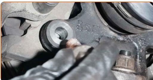
**78** Aparafuse os fixadores do suporte da pinça de travão. Use uma chave soquete nº 18. Use uma chave de catraca.
