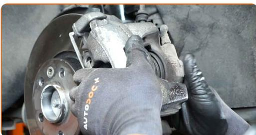
**77** Instale os parafusos de fixação.
