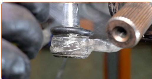
**47** Limpe o elemento de fixação que conecta o terminal de direção à manga de eixo. Use uma escova metálica. Use spray WD-40.
