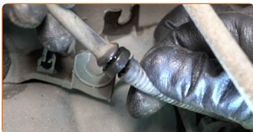
**28** Desaparafuse o fixador que conecta a bieleta da barra estabilizadora à coluna do amortecedor. Use uma chave soquete nº 15. Use uma chave de catraca.
