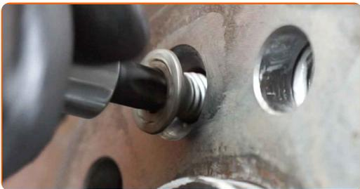
**75** Aperte os fixadores do disco de travão. Use Torx T50. Use uma chave de torque. Aperte-o para o torque de 15 Nm.
