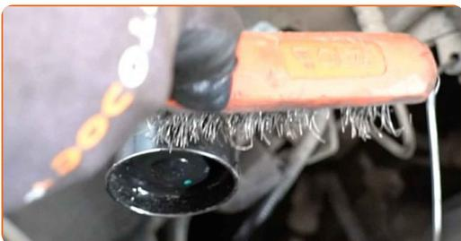
**45** Limpe o parafuso que liga a biela da barra estabilizadora à torre de suspensão. Use uma escova metálica.
