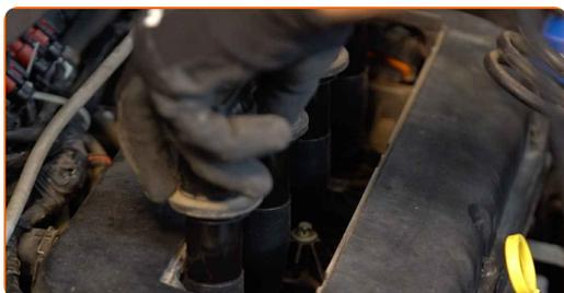
**7** Limpe a sujidade, poeira e detritos de dentro dos poços das velas de ignição.
