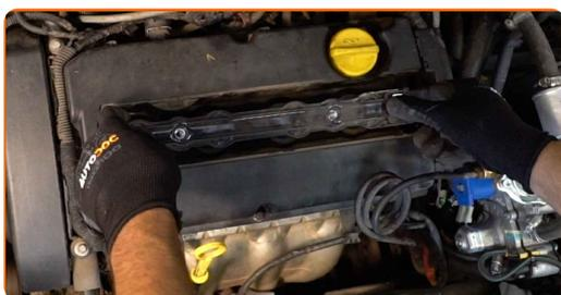
**15** Apertar a fixação da bobina de ignição. Use Torx T40. Use uma chave de catraca.
