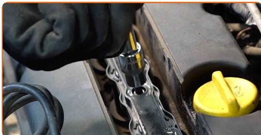
**16** Trate o conector da bobina de ignição com spray eletrónico. O spray protegerá os contactos eléctricos contra a corrosão, oxidação e reduzirá a resistência do contacto.
