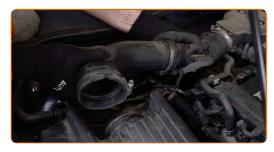
Conecte o tubo de entrada de ar ao compartimento do filtro de ar.
