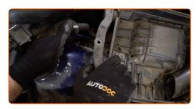
Desencaixe o suporte da lâmpada girando-o cerca de 30°. Retire o suporte do local de montagem no farol.
