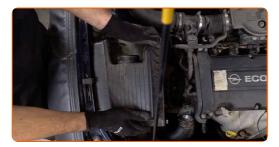
Desapertar os parafusos de fixação da caixa do filtro. Use Torx T30. Use uma chave de catraca.
