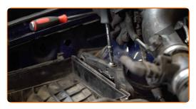
Insira o cartucho do filtro na caixa do filtro. Certifique-se de que a borda do filtro encaixa-se perfeitamente na caixa.
