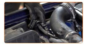
Retirar a tampa do filtro. Remova o elemento de filtro a partir da caixa do filtro.
