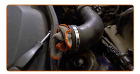
Desconecte os fixadores que conectam o tubo de ar e o feixe de cabos à caixa do filtro de ar.
