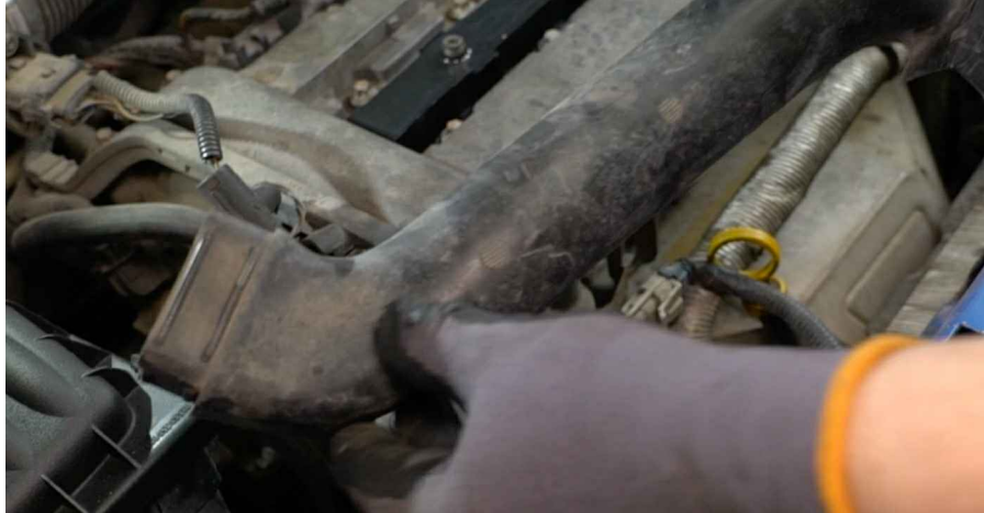
15 Limpe as ligações do tubo do líquido de refrigeração. Use o spray de limpeza universal.
