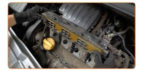
Limpe a sujidade, poeira e detritos de dentro dos poços das velas de ignição.
