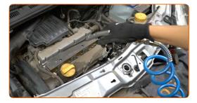
Desconecte o conector da bobina de ignição. Use uma chave de fenda plana.
