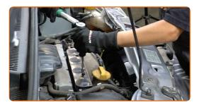
Trate o conector da bobina de ignição com spray eletrónico. O spray protegerá os contactos elétricos contra a corrosão, oxidação e reduzirá a resistência do contacto.
