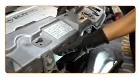
Aparafuse os fixadores do conjunto da caixa de distribuição de ar. Use Torx T20.
