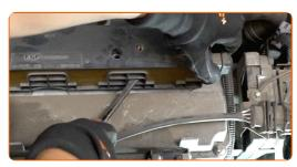
Retire a bobina de ignição do orifício da vela de ignição.
