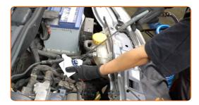
Ligue o conector da bobina de ignição. Certifique-se que ouve um clique a indicar que está fixa no local.
