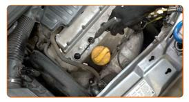
Instale a bobina de ignição nova no orifício da vela de ignição. Certifique-se que ouve um clique a indicar que está fixa no local.
