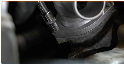
**35** Aperte os fixadores da carcaça do termóstato. Use uma chave soquete nº E8. Use uma chave de torque. Aperte-o para o torque de 7 Nm.
