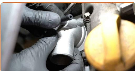
**34** Aparafuse os fixadores da carcaça do termóstato. Use uma chave soquete nº E8. Use uma chave de catraca.
