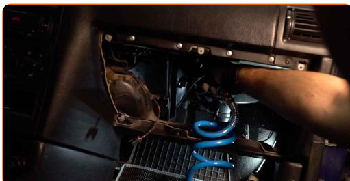
Substituição: filtro de ar – VAUXHALL Astra Mk V (H) (A04) Hatchback.
