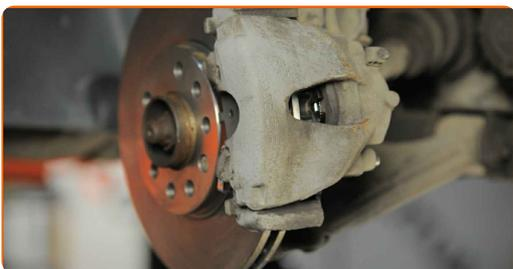
**31.2** Use HEX n.º H7 Use uma chave de torque. Aperte-o para o torque de 30 Nm.
