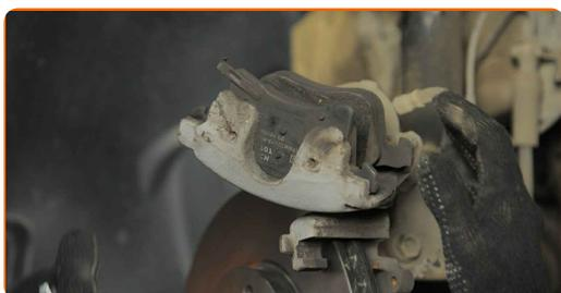
Substituição: discos de travão – VAUXHALL Astra Mk V (H) (A04) Hatchback.
