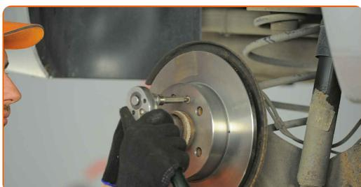
**17** Limpe os locais de montagem da pinça e o seu suporte. Use uma escova metálica. Use spray WD-40.
