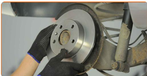
**16** Aperte a fixação do disco de travão. Use Torx T30. Use uma chave de torque. Aperte-o para o torque de 4 Nm.
