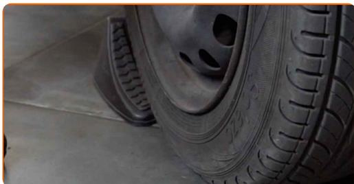
**4** Solte os parafusos de montagem das rodas. Use o soquete de impacto para roda #17.
