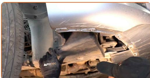
**15** Instale e aperte os elementos de fixação da cobertura do arco da roda. Use Torx T25.
