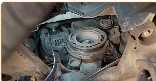
Substituição: correia trapezoidal estriada – VAUXHALL Astra Mk V (H) TwinTop (A04). Conselho:
