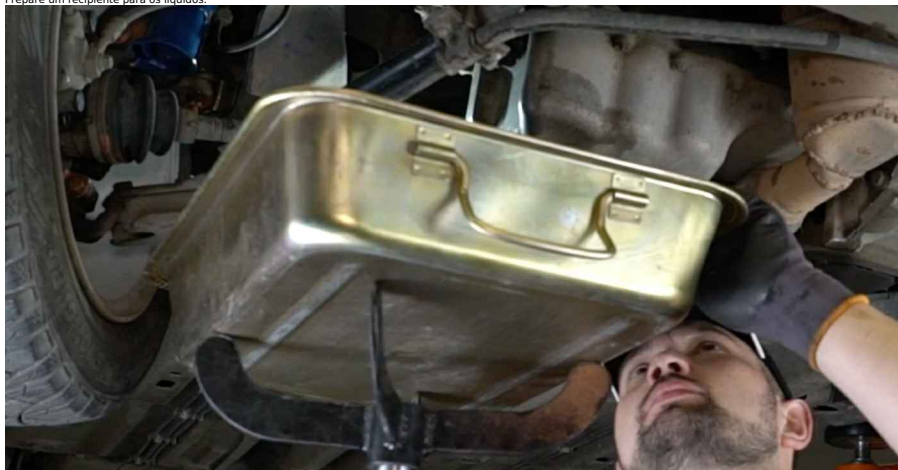
7 Solte a braçadeira de fixação da mangueira do líquido de refrigeração. Utilize alicates de anel clic-R.
