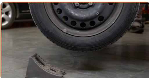
**5** Desaperte os parafusos da roda.
