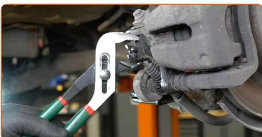
**9** Desaparafuse a fixação de pinça de travão. Use uma chave combinada nº 13. Use uma chave combinada nº 17.
