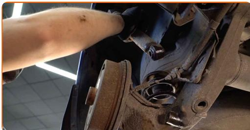
**Substituição: amortecedor – VAUXHALL Astravan Mk IV (G) (T98). Conselho da AUTODOC:**
