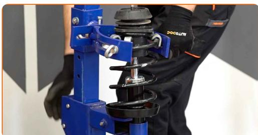
**31** Retire a coluna de suspensão montada.
