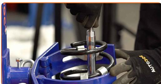
**28** Instale o suporte, a coifa e o batente de encosto do amortecedor no novo amortecedor.
