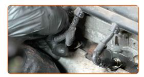
Desaparafuse as velas de incandescência. Use o soquete da vela de ignição #8. Use uma chave de catraca.
