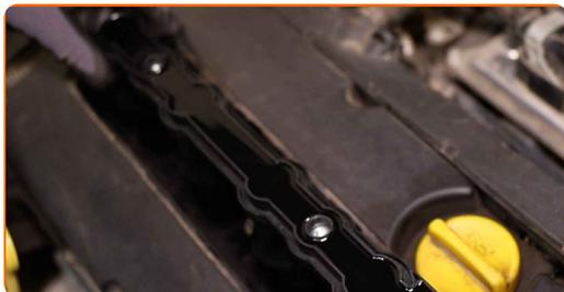
**10** Aparafuse os parafusos da bobina de ignição. Use Torx T40. Use uma chave de torque. Aperte-o para o torque de 7 Nm.
