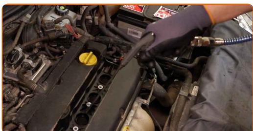
**9** Instale a bobina de ignição nova no orifício da vela de ignição.
