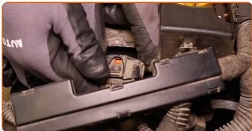
**5** Desaparafuse os parafusos da bobina de ignição. Use Torx T40. Use uma chave de catraca.
