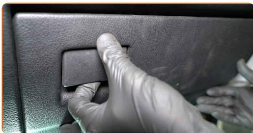
**20** Aparafuse os parafusos de fixação do porta-luvas. Use Torx T20.
