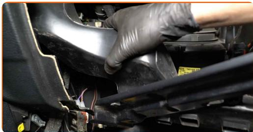
**9** Solte os clips da tampa do filtro do habitáculo. Use uma ferramenta de remoção de clipe.
