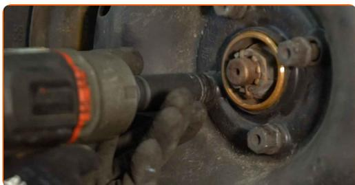
**23** Baixar o carro e trabalhar em ordem transversal, apertar os parafusos das rodas. Use uma chave de torque. Aperte-o para o torque de 110 Nm.
