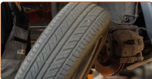
**8** Desaparafuse e remova os elementos de fixação da cobertura do arco da roda. Use Torx T20.
