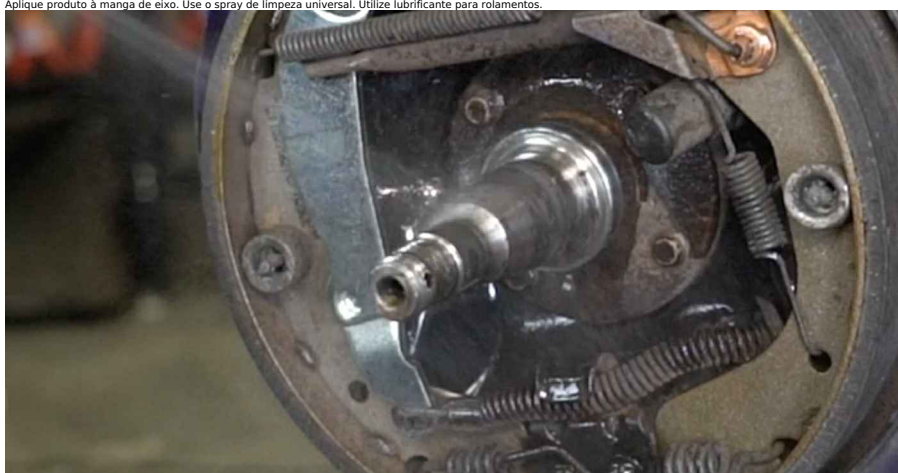
24 Instale o tambor de travão montado com a chumaceira do cubo de roda.
