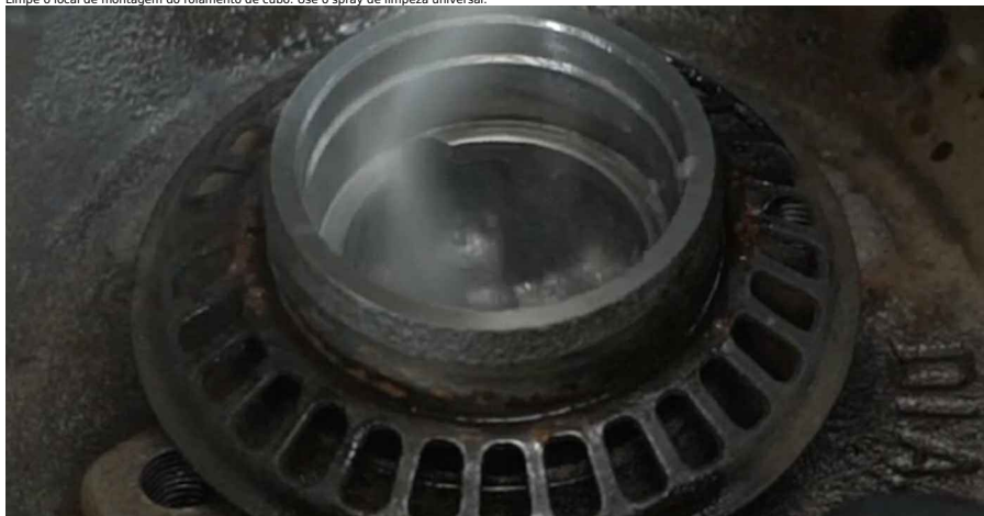
18 Monte um anel exterior do rolamento da roda novo no tambor do travão. Kit de saca casquilhos e rolamentos.
