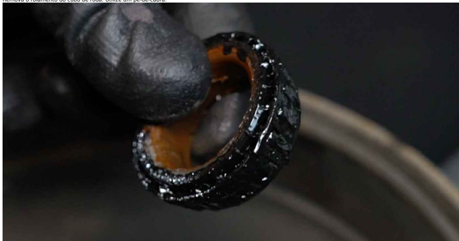
14 Limpe o local de montagem do rolamento de cubo.
