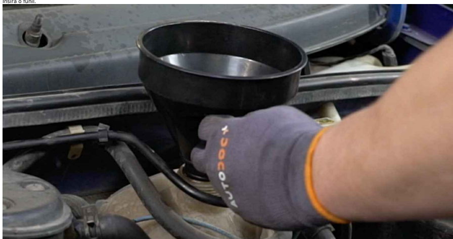
35 Verta o líquido de refrigeração no reservatório do líquido de refrigeração.
